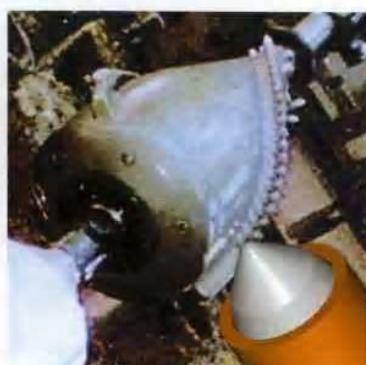
Perforazioni orizzontali direzionali HDD
